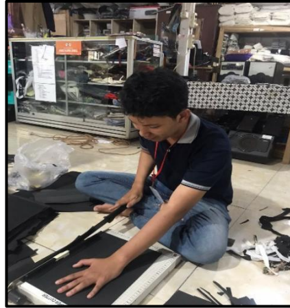
Gambar 6 Proses pemotongan spon
