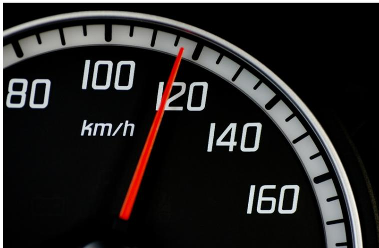
Pengukuran kecepatan sesaat secara langsung menggunakan alat yang bernama "**Speedometer**". Speedometer dipakai kendaraan bermotor yang berguna untuk menunjukkan kecepatan sesaat kendaraan bermotor sewaktu melaju di jalan. Satuan ukuran kecepatan sesaat pada speedometer adalah km/jam.
