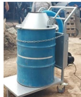
Incenerator, alat untuk membakar residu sampah (alat ini akan diberikan kepada mitra)
