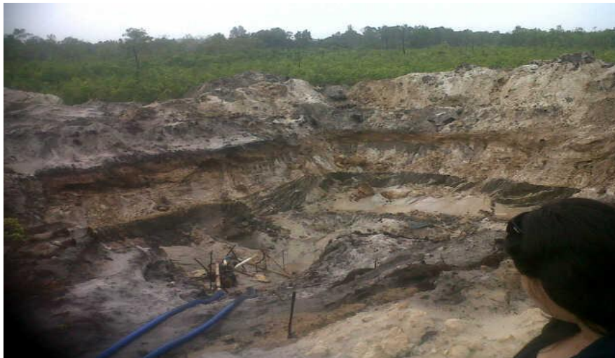
Gambar 2 : alat dan pipa yang digunakan penambang dalam menghisap pasir dan timah
