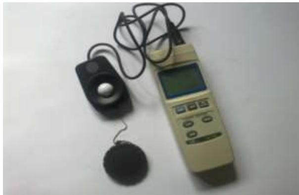
Gambar 4.16. Alat Pengukur Intensitas Cahaya *Light Meter*
