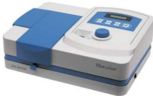
Gambar 4.12. Alat Pengukur Kadar Klorofil Daun *Spectrophotometer*
