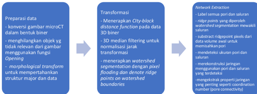
Gambar 6. Workflow dari algoritma yang diajukan untuk mendeteksi dan mengekstrak jaringan pori.
