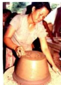
Membentuk badan gerabah dengan alat putar tangan tradisional
