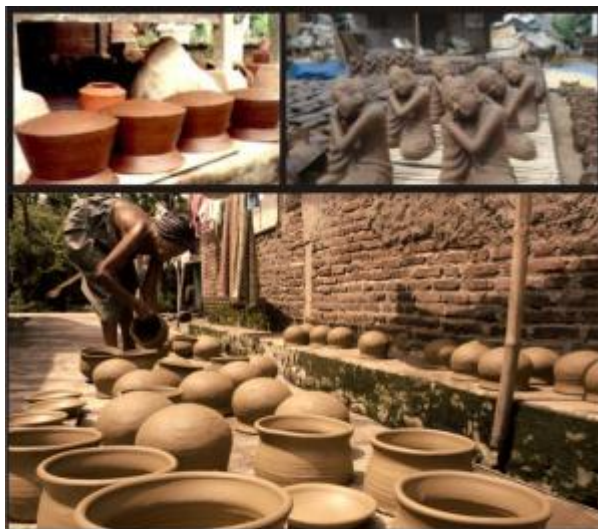
Gambar 8. Pengeringan gerabah dengan panas matahari
