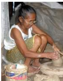
Membentuk badan gerabah dengan alat putar tangan tradisional
