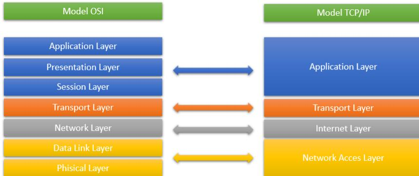
Gambar 8.4: Model OSI dan TCP IP
