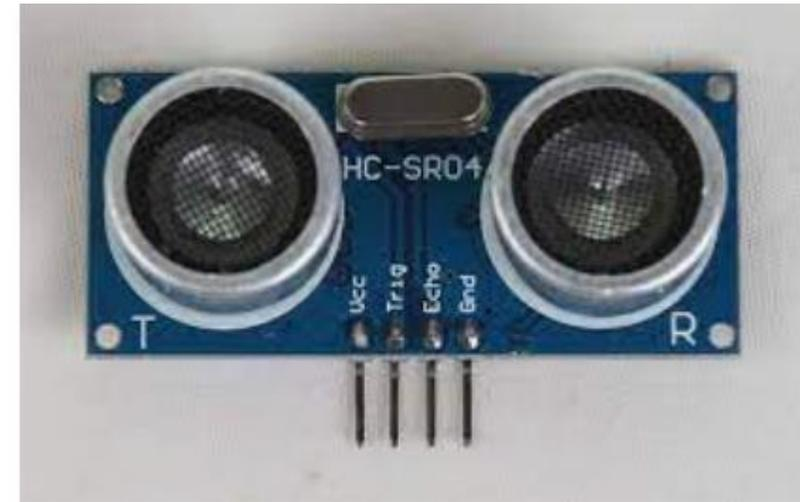
Contoh sensor jarak adalah sensor ultrasonic (bentuk seperti pada gambar di atas)
