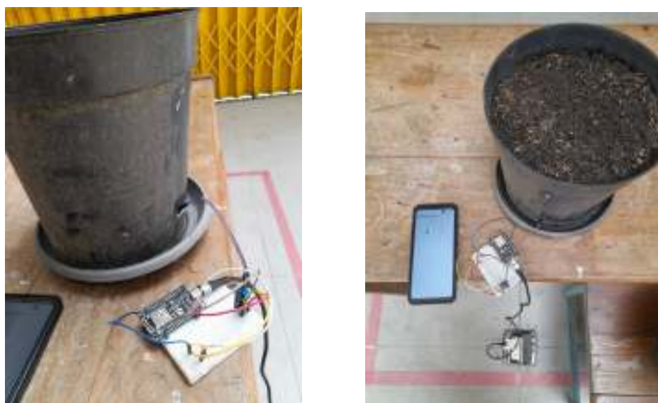
Gambar 4.6 Posisi sensor pada pot dan pengujian pembacaan data kelembaban pada aplikasi handphone .
