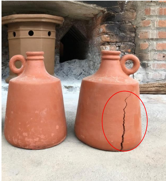
Gambar 4.3. Bentuk Produk Guci Reject Retak (Sumber: Pribadi)
