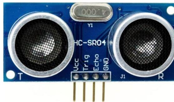
Gambar 3.6 Sensor Ultrasonik.
