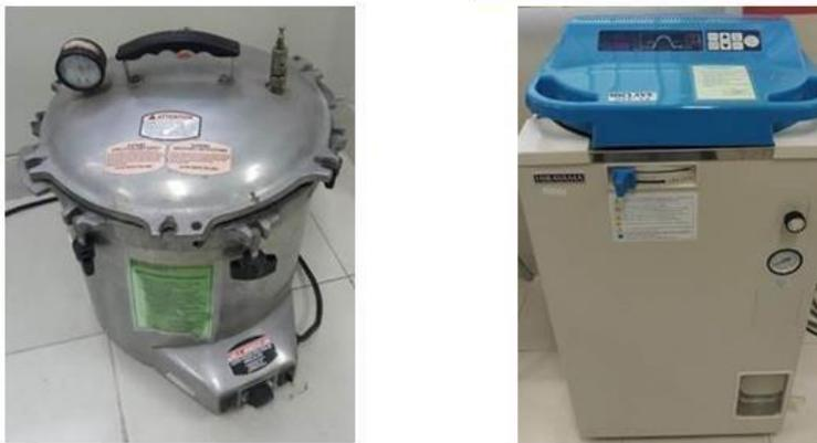
Gambar 9. Autoklaf manual dan otomatis
